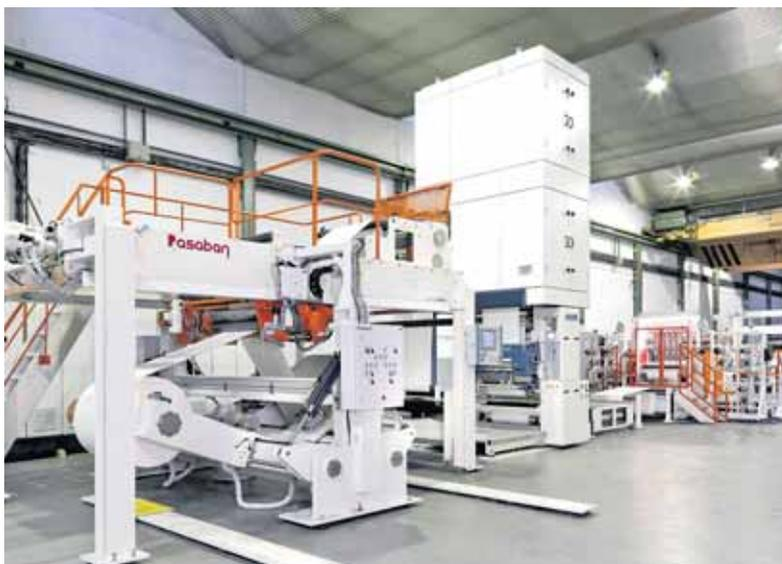
Línea de aplicación de elementos de seguridad vía estampación, láser e impresión.
